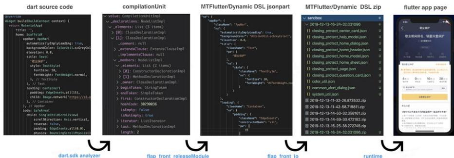
图 2 DSL-JSON 的转换步骤
